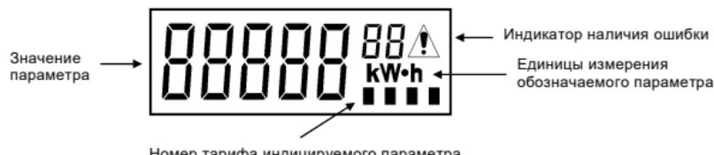
Рисунок 2.1 – Расположение информации на индикаторе
